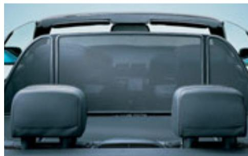
□ **Windschutz** ermöglicht genussvolles Offenfahren ohne lästige Zugluft und störende Verwirbelungen im Schulter- und Nackenbereich; das Windschott lässt sich einfach bedienen, ist doppelt klappbar und kann deshalb platz sparend im Gepäckraum verstaut werden.
