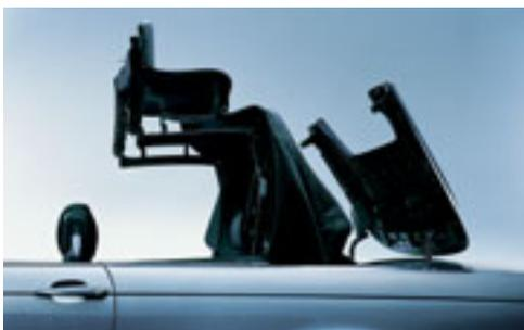
■ **Verdeck**, elektrisch: Die Funktion Öffnen/Schließen des Verdecks (bei stehendem Fahrzeug) läuft vollautomatisch per Tastendruck im Innenraum oder über das Türschloss ab. Das Öffnen des Verdecks ist zusätzlich über die Funkfernbedienung möglich.
