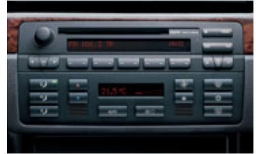
□ **BMW Professional**, Ausstattung wie BMW Business, darüber hinaus 2-Tuner-Frequenz-Diversity (zwei Tuner suchen permanent den besten Empfang und schalten unhörbar auf die beste Frequenz um), integriertes, nicht MP3-fähiges CD-Laufwerk, motorischer CD-Einzug/-Ausschub, Anschluss für BMW CD-Wechsler (nicht in Verbindung mit Navigationssystem).
