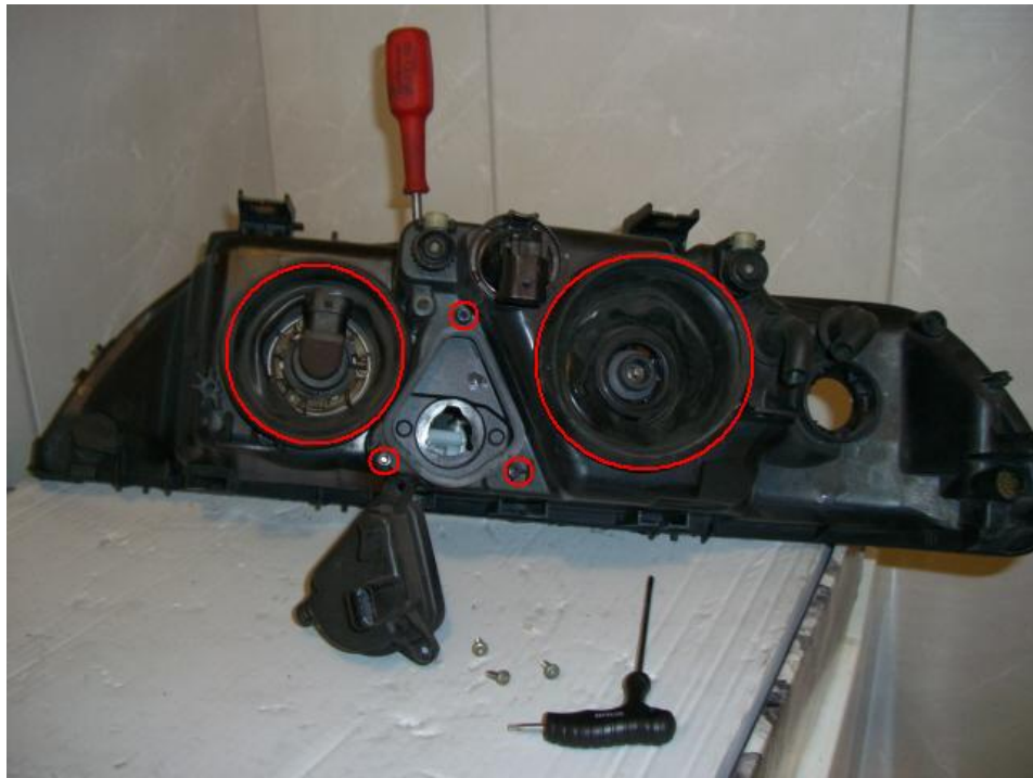
Die Gummiabdeckungen vom Fern- und Abblendlicht abheben, die drei Torx Schrauben der Leuchtwertenregulierung entfernen (LWR NICHT RAUSZIEHEN) sondern wie auf dem Bild mit einem Schraubenzieher SEITLICH RAUSDRÜCKEN.
