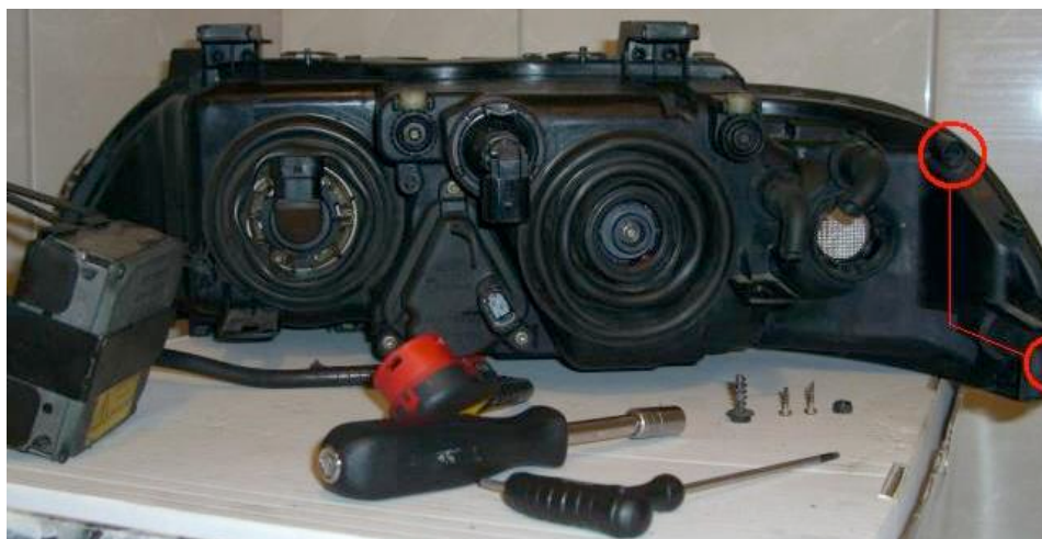
Vorschaltgerätstecker durch das drehen nach links abkoppeln und die 3 Schrauben rausdrehen, Die zwei seitlich befindlichen Torx Blinkerglasschrauben rausdrehen.
