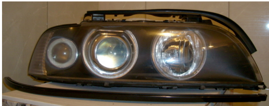
Untere Leiste und oberen Gummi aushängen.
