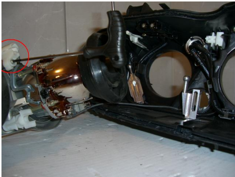
Die Torx Schrauben der beiden Kugelhalterungen abschrauben, abgebrochene Plastikkugeln der defekten Reflektorhalterungen vorsichtig mit einem kleinem flachen Schraubenzieher (am besten zu zweit) rausdrücken und die Kugelhalterungen wieder montieren.
