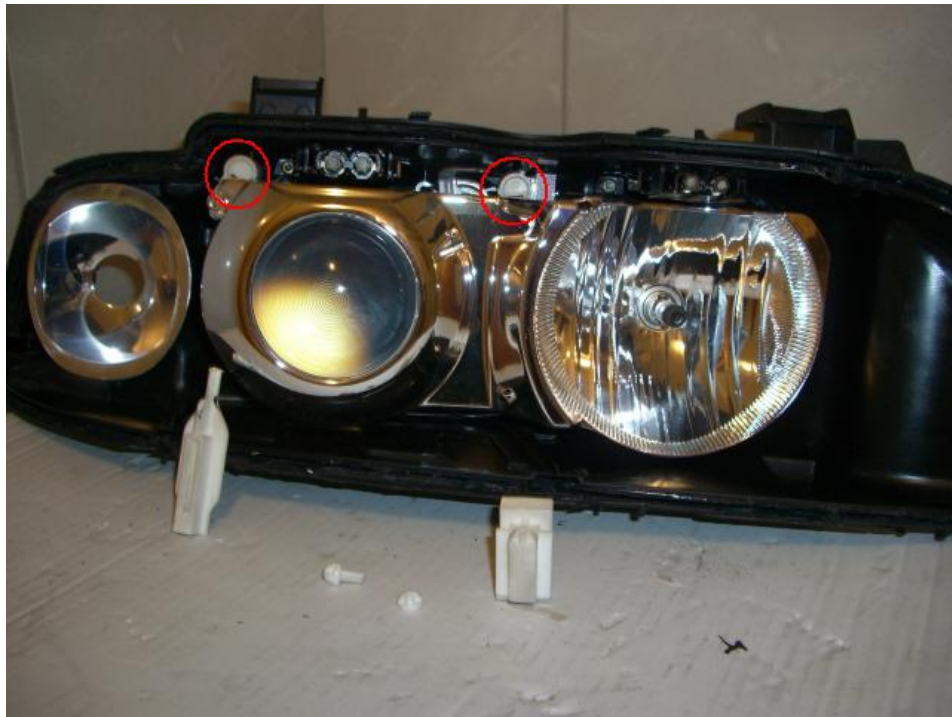
Kugel der Reflektorhalter in die Kugelhalterungen eindrücken und einrasten lassen.
