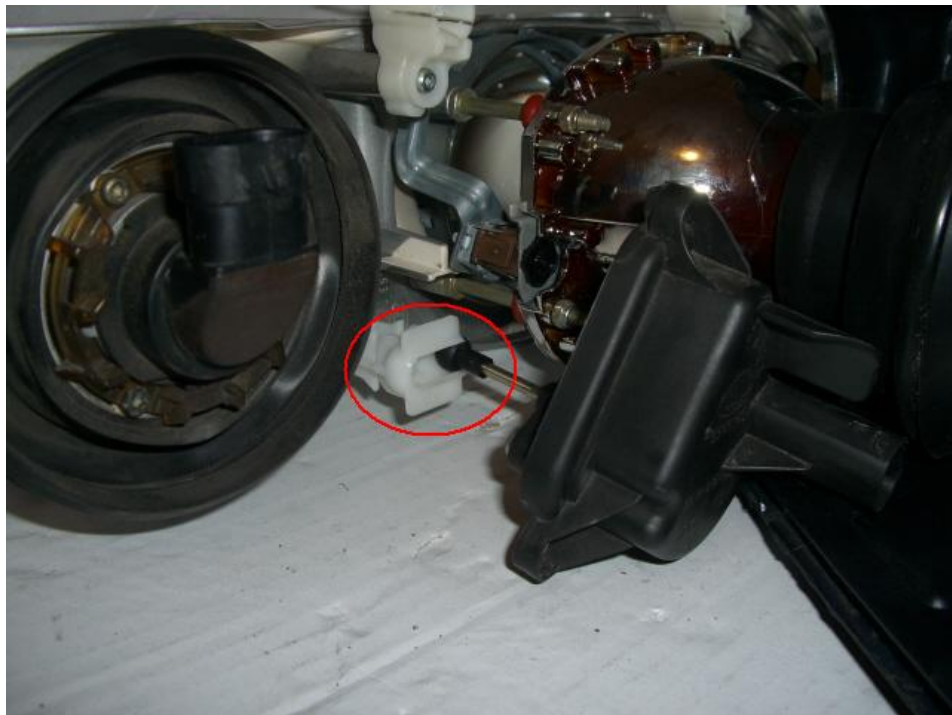
Leuchtweitenregulierung provisorisch von hinten einstecken und die schwarze Kugel von der Seite mit einem langem Schraubenzieher in die dafür vorgesehene Halterung drücken, anschließend die LWR mit den drei Torx Schrauben wieder befestigen, Abblend- und Fernlichtgummis wieder aufstecken.
