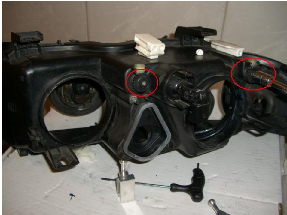
Alte Reflektorenhalterungen durch das Linksdrehen an den 10er Einstellschrauben aushängen (langes Gewinde).
