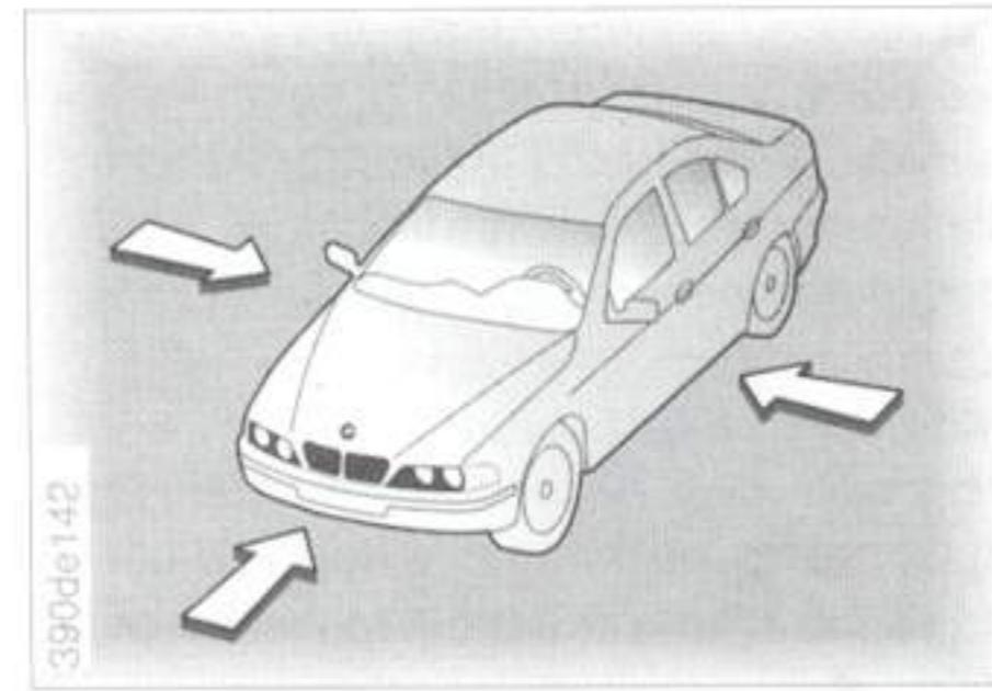
Na obrázku vidíte směry nárazu, při kterých chrání airbagy cestující ve voze před zraněním. Ochrana v bočních směrech platí pouze za předpokladu, že je vůz vybaven bočními airbagy.
