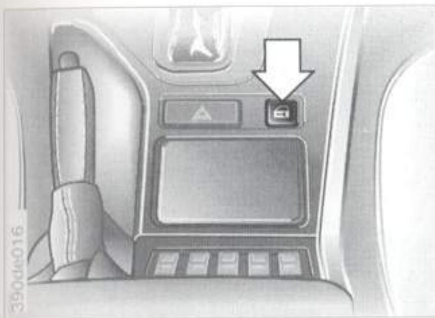
Tímto tlačítkem se ovládají přední dveře centrálním zamykáním. Odemykají, popř. zamykají se dveře, víko, popř. dveře za vazadlového prostoru a dvířka hrdla palivové nádrže, přičemž nedojde k zajištění proti odcizení.
