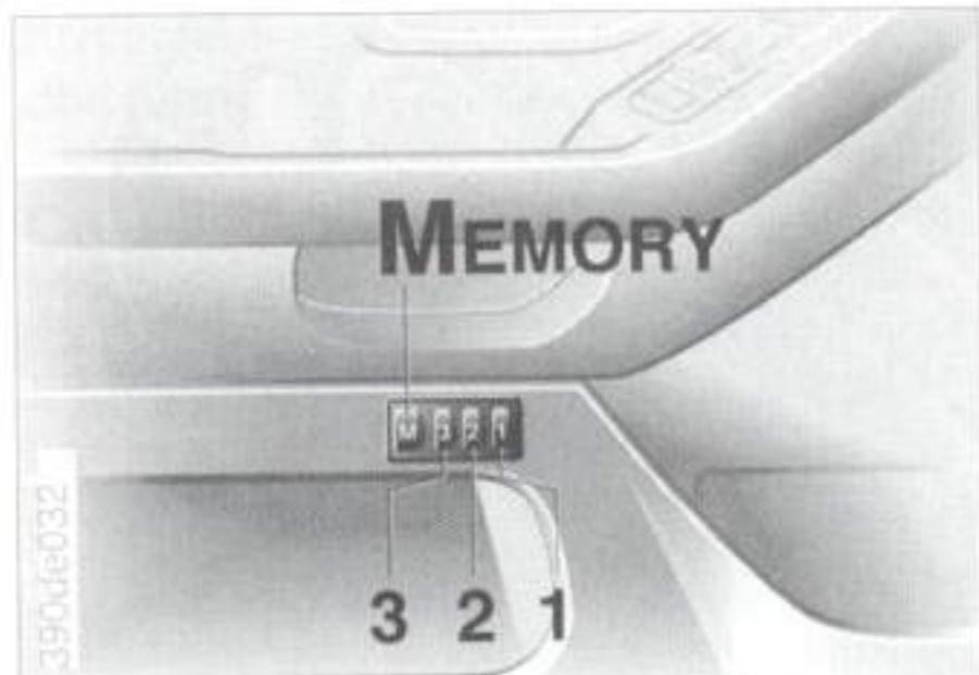
Máte možnost uložení do paměti a následného vyvolání tří poloh sedadla řidiče, zrcátek a volantu (pouze ve spojení s elektrickým nastavováním volantu). Obrázek znázorňuje uspořádání tlačítek na dveřích řidiče.
