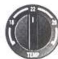
Hodnoty na stupnici jsou orientační hodnoty teploty. Jako základní se doporučuje nastavení na 22 °C. Po zapo-četí jízdy je teplota co možno nejrychleji dosažena a následně automaticky udržo-vána.
