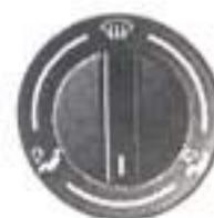
Můžete volit přívod vzduchu na okna , na horní část těla a do prostoru nohou . Jsou
