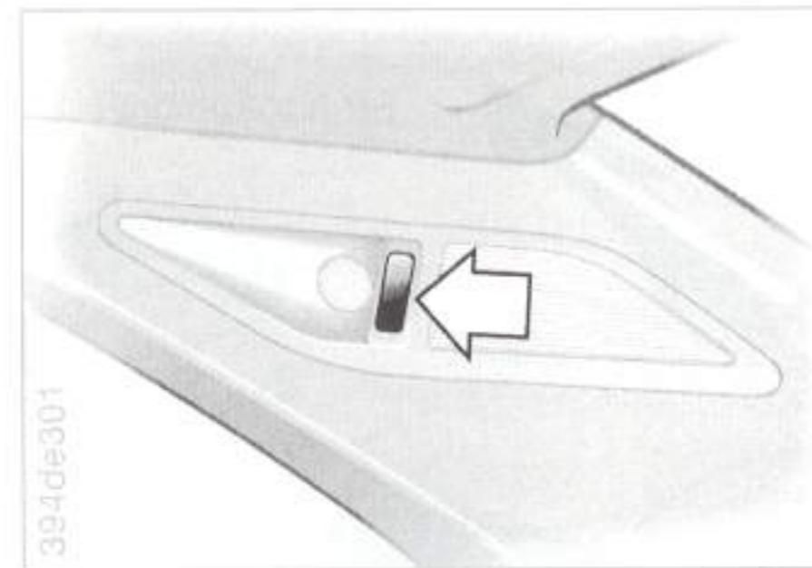
Lampičky na čtení jsou umístěna po stranách osvětlení interiéru vpředu, popř. vzadu. Tlačítkem (označené šipkou) u světel můžete světla zhasnout a rozsvítit.
