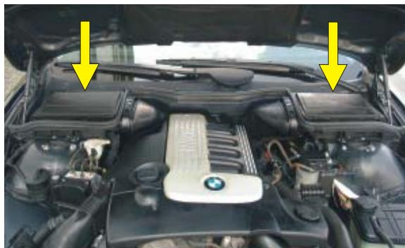
**PL** Podnieść maskę przednią. Filtry przeciwpłytkowe znajdują się w symetrycznie rozmieszczonych prostokątnych obudowach
