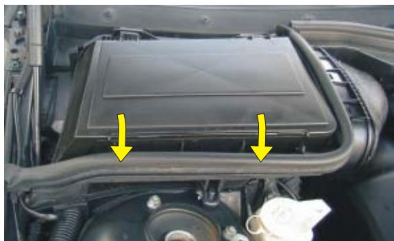
**PL** Odpiąć zaczep mocujący, wyjąć pokrywę filtra
