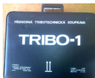
Meracia súprava, prípravok na meranie kinematickej viskozity
