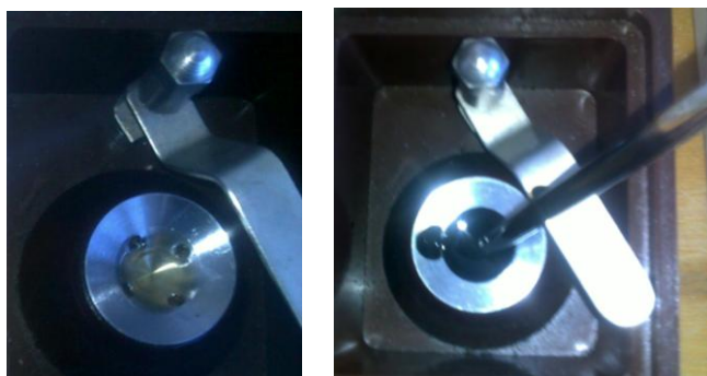
Vzorkovanie referenčného a použitého MO do prístroja
