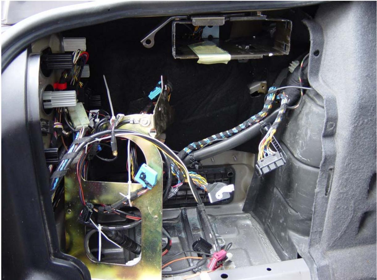
Nun kann die hintere Dämmmatte umgeklappt werden. Dazu muss eine Spreizniete herausgenommen werden.
