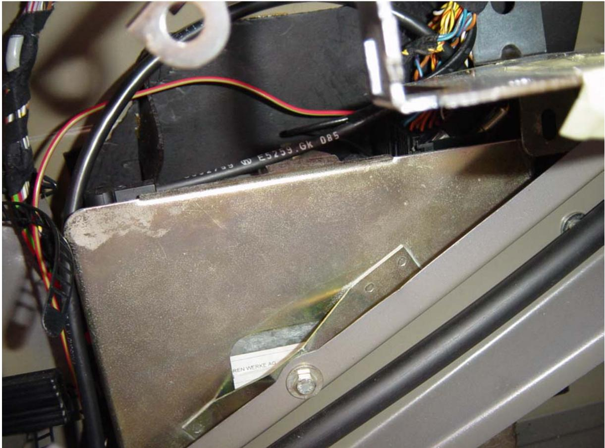
Dieses ist an einer Traverse mit zwei Schrauben befestigt.
