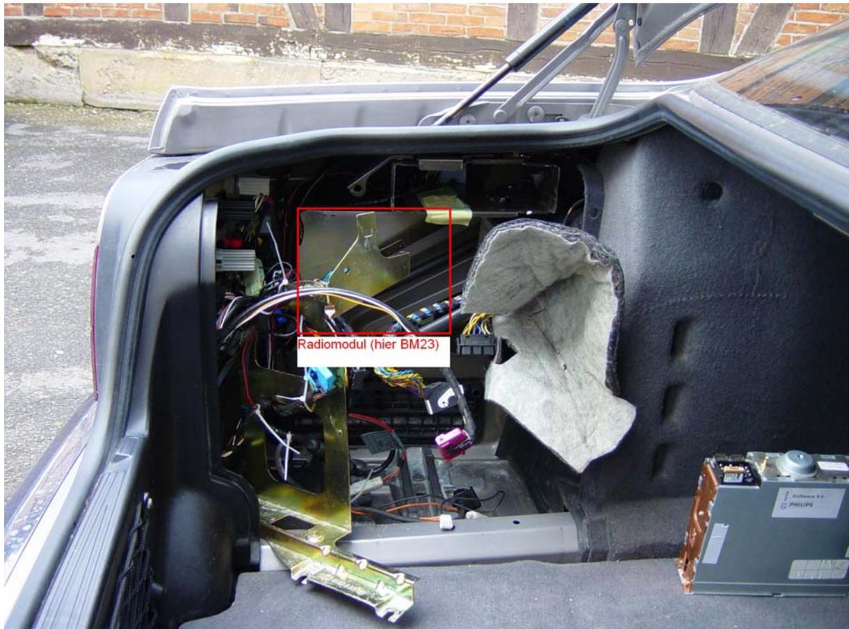
Um das Radiomodul herausnehmen zu können muss nun die Halterung für den Navirechner raus. Dazu müsst Ihr die zwei Muttern am Deckel der Navihalterung abschrauben:
