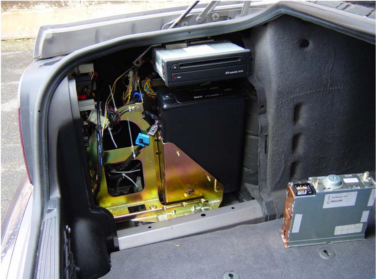
So sieht's ohne Verkleidung aus - Navirechner wieder eingesteckt, da ich die Verkleidung bereits am Vortag abgebaut habe.
