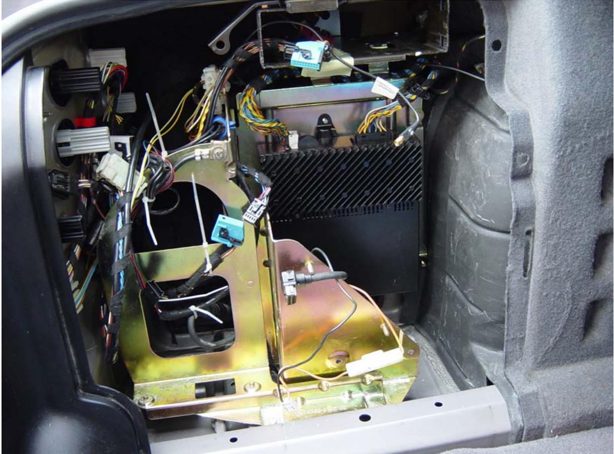
Falls vorhanden kann nun das Videomodul ausgebaut werden. Dort müssen nur die Stecker abgezogen und die Schraube oben gelöst werden. Mein VM ist bei der Aufrüstung MK1 -> MK3 auf der Strecke geblieben.
