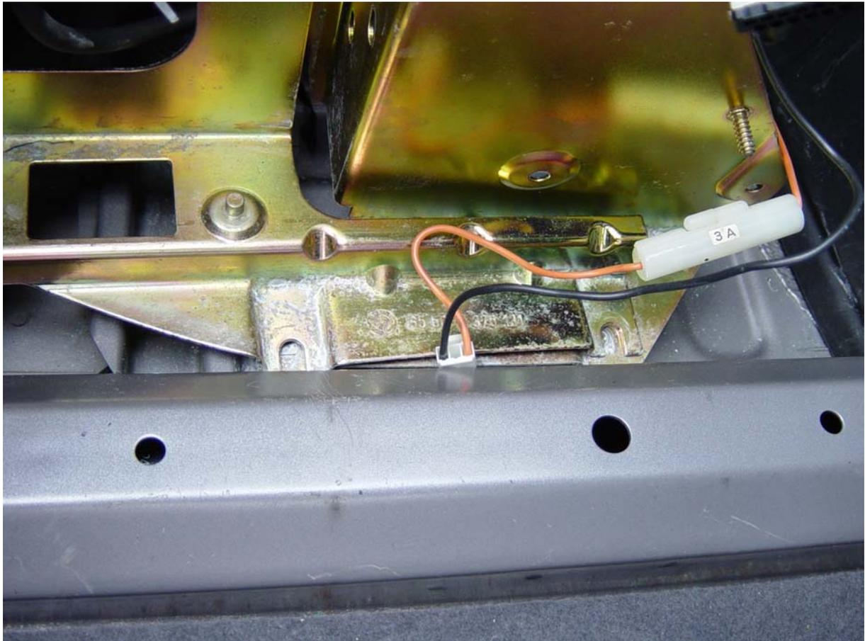
Die zwei Schrauben am Boden der Halterung ausschrauben (siehe Bild oben). Dann am oberen linken Ende der Halterung die Schraube lösen:
