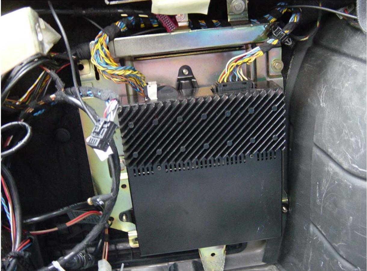
Es wird die gesamte Verstärkerhalterung ausgebaut, NICHT der Verstärker alleine.
