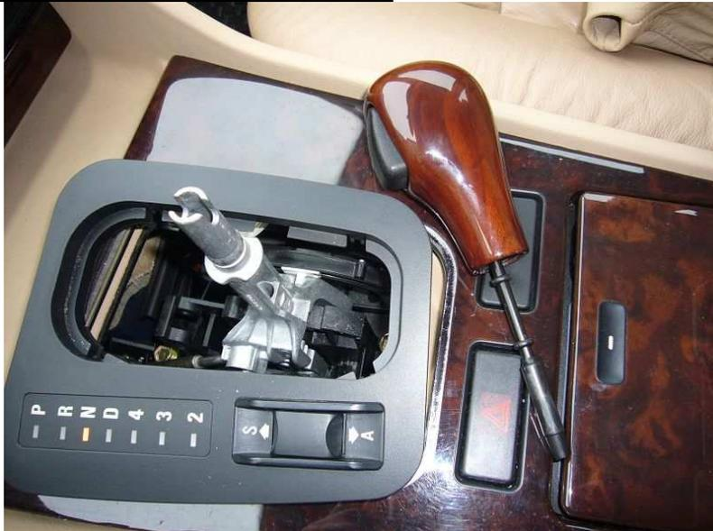
**AUFPASSEN, dass die Schaltfläche nicht großartig hin- und hergedreht wird oder zu weit nach oben gezogen wird, da sich darunter SEHR KURZE KABEL für Sporttaster (rechts im Bild), Schaltelement (der schwarze Stecker gleich mittig im Bild) und Schaltung (der graue verdrehte im Bild hinten) befinden:**
