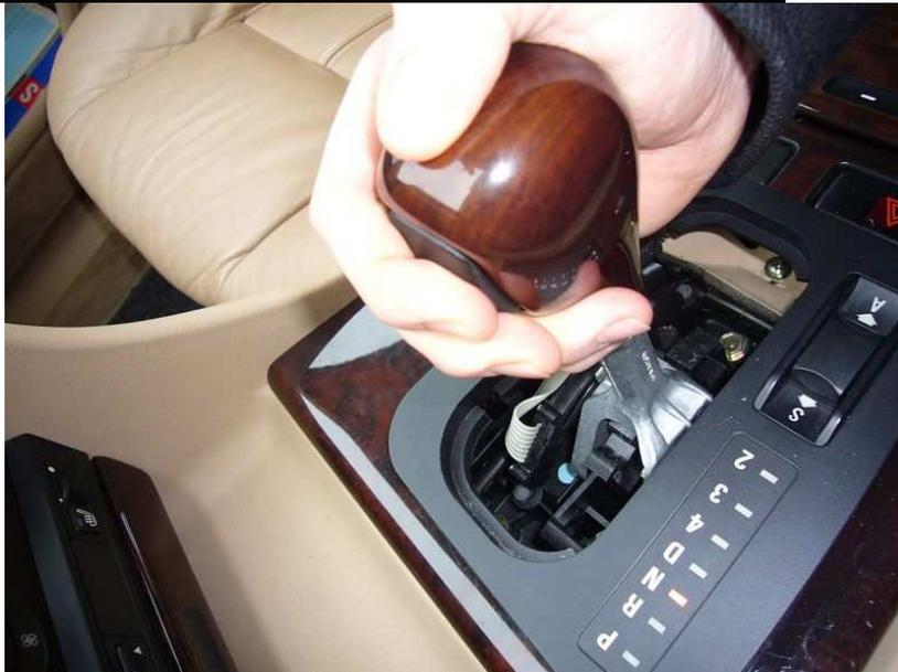
Danach sollte es so aussehen, s. Bild. Die Schaltfläche „fliegt“ gleich mit aus ihren Metallklammern, es geht aber nichts kaputt. Auf dem Bild ist die Schaltmanschette schon aus ihren vier Halterungen (s. die Einkerbungen auf der Schaltfläche) rasugeclipst, **AUFPASSEN; dass auch dabei keine abbricht!**
