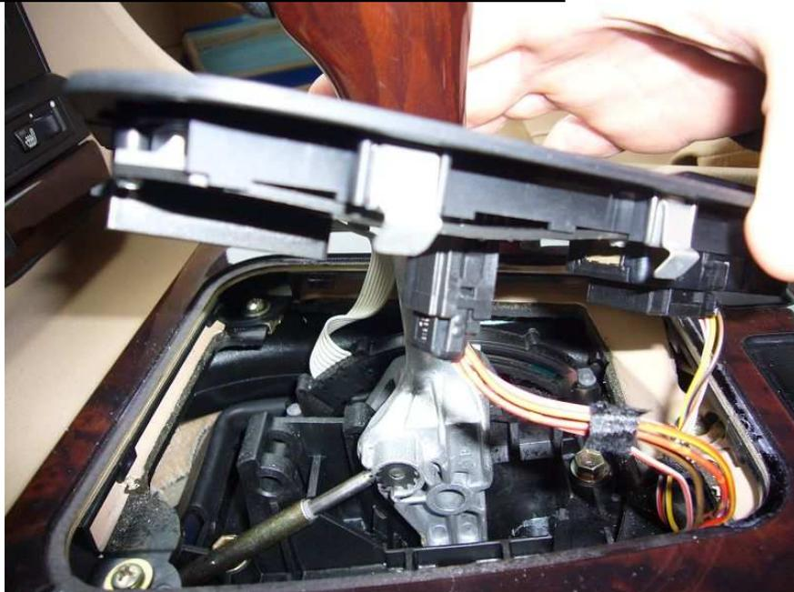
Dann die neue Schaltmanschette auf den „entblößten“ Wählhebel setzen und reinclipsen. Schauen, das alles passend sitzt, auch die Schaltfläche, und vor allem keine Kabel, besonders das graue flache, irgendwo geklemmt wird:
