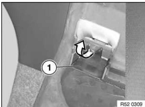
Ggf. defekten Klipp (1) aus Karosserie ersetzen:
