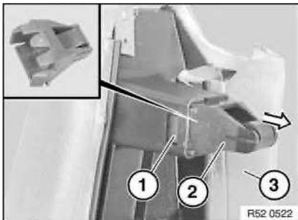
Ggf. defekten Klipp (2) aus Lehnenseitenteil ersetzen:
